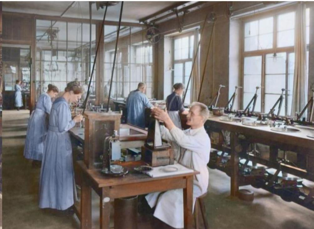
Prüfen der Radien optischer Linsen mit dem Sphärometer
