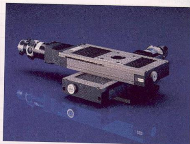
Eine XY-Baugruppe mit Lineartischen der M-UTM-Serie ist eine kostengünstige Lösung, wenn geringe Lasten exakt positioniert werden sollen. Diese Positionierer können mit einer Orthogonalität von \pm 50 \mu\text{rad} ausgerichtet werden.
