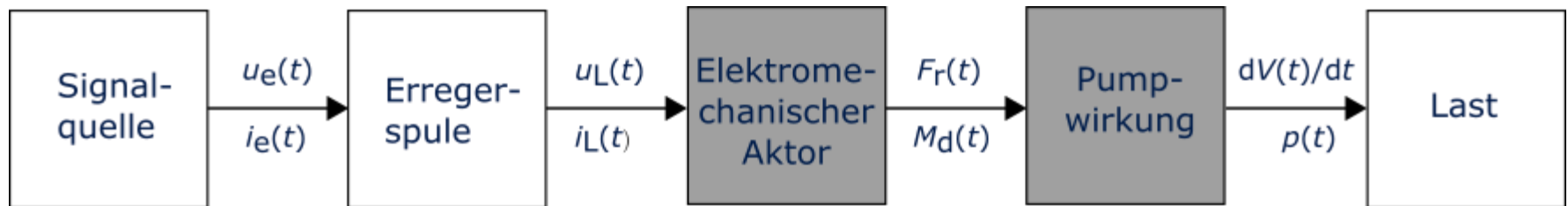
Funktionsstruktur der Pumpe
