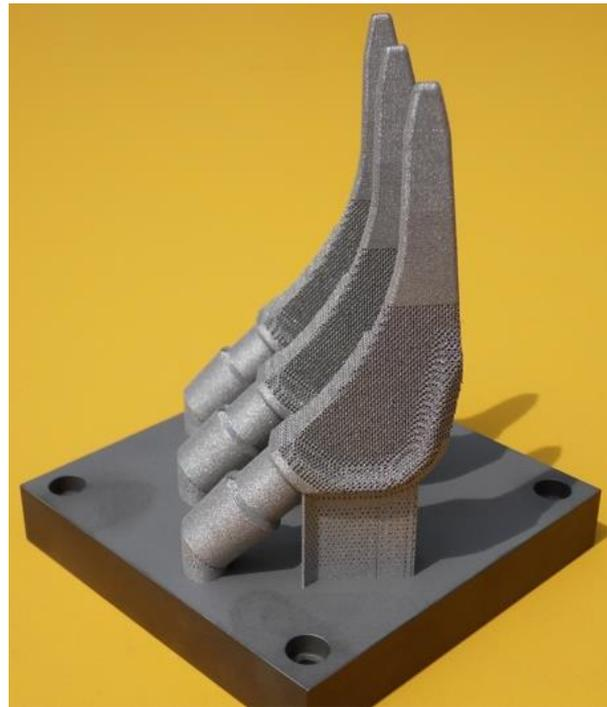
Laserstrahlgeschmolzene Implantate auf der Bauplattform
