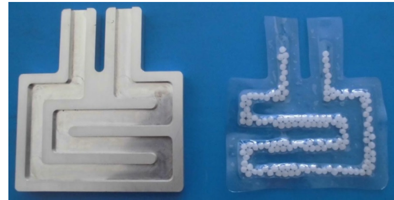
Aluminiumform und PVC-Mäander gefüllt mit Kunststoffkugeln
