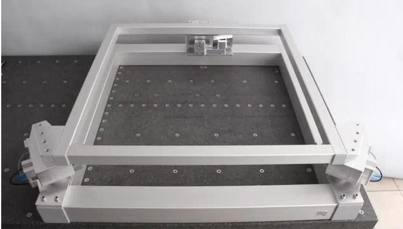
Demonstrator mit Direktantrieben und Luftlagern – X,Y und Phi- Bewegungen
