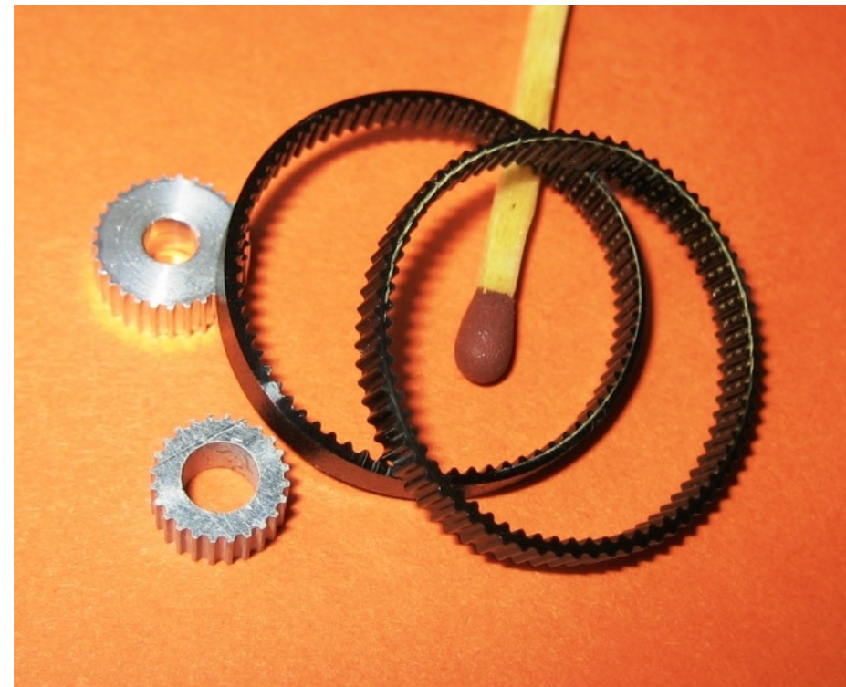
Ein- und zweiseitig verzahnter Riemen (Eigenentwicklung), exemplarisch ausgewählte Zahnscheiben
