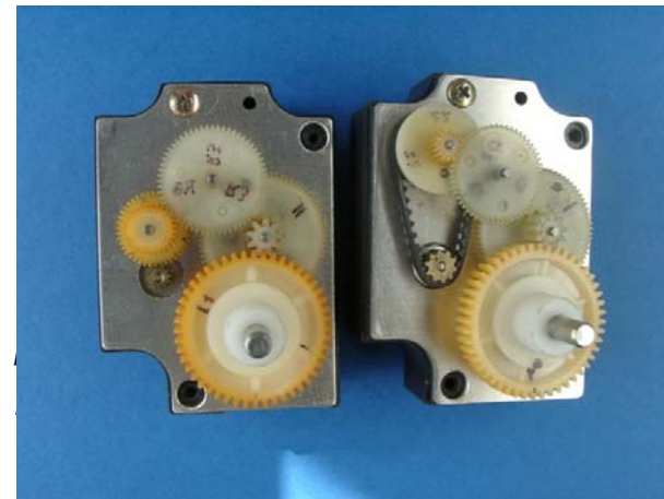
Projektstudie IFTE; Kleinantrieb mit Schrittmotor, vor (links) und nach (rechts) der Optimierung
