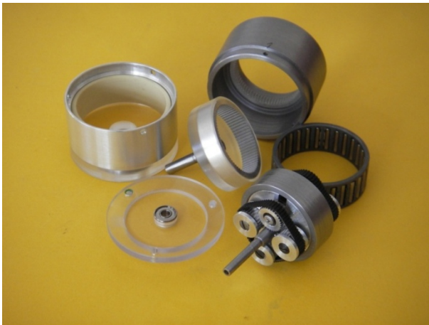
Ansicht des demontierten Getriebes
