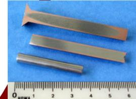
Durch Strangpressen hergestellte Massivproben aus mechanisch legierten Pulvern.
