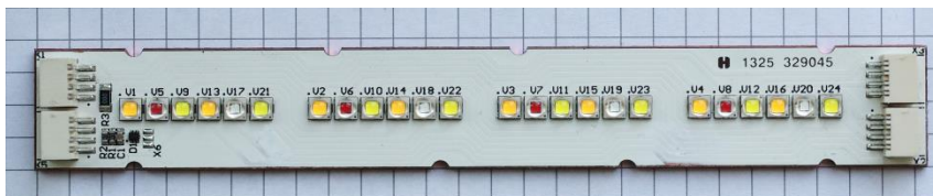
Abbildung 3: LED-Platine mit 4 verschiedenen LED-Typen
