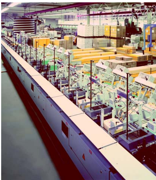
Bild 6: Zusammentragmaschine als ein Anwendungsbeispiel für die Simulation
