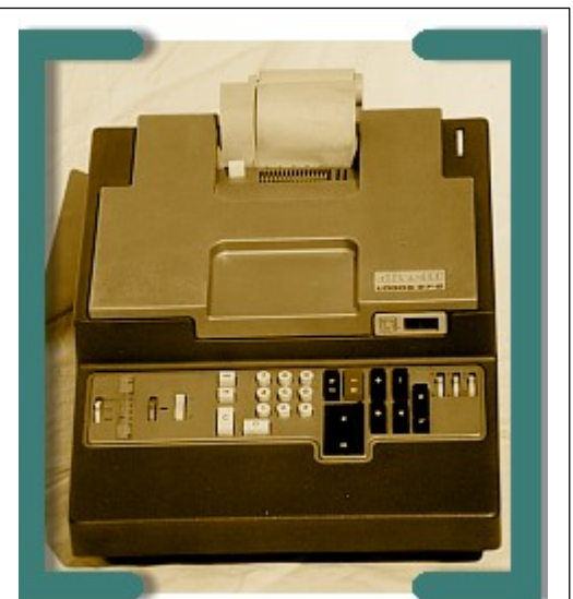
Bild 5: Olivetti Logos 27-2, 1966 druckender Rechenautomat Quelle: E. Anthes
