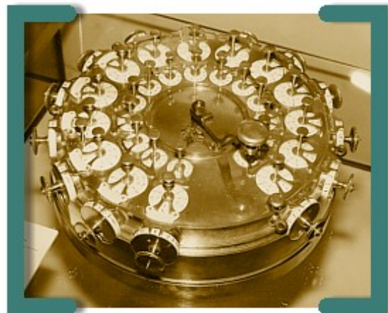
Bild 1: Staffelwalzenmaschine von J.H. Müller, 1784 (Hess. Landesmuseum Darmstadt) Quelle: E. Anthes
